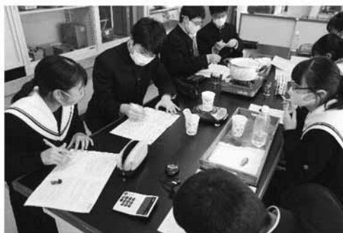
図1 金属の比熱を測定する実験の様子
